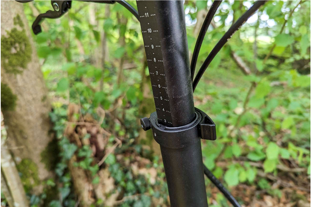
Die Lenkerhöhe lässt sich per Schnellspanner einstellen.
