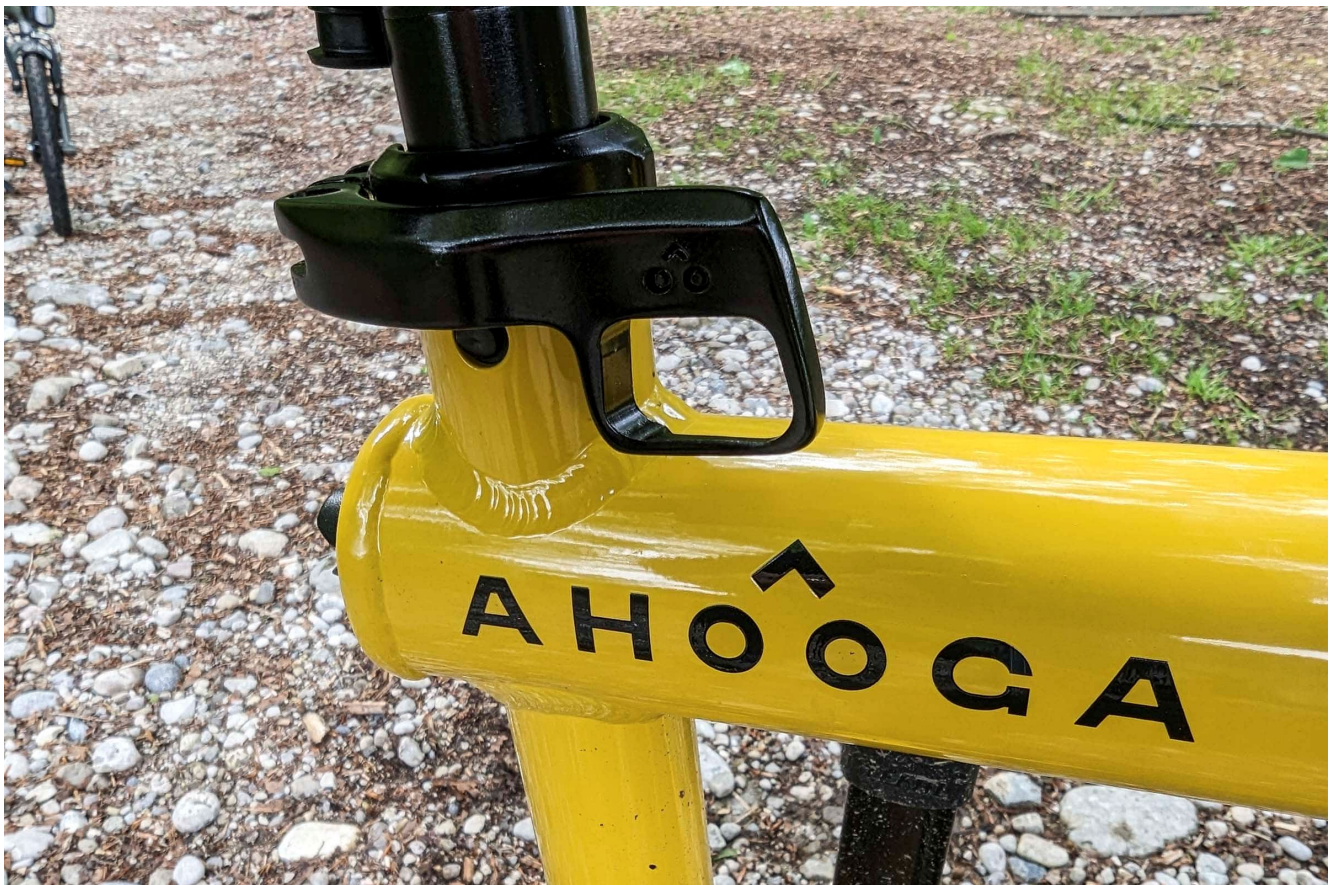
Der große Schnellspanner lässt sich gut bedienen.
