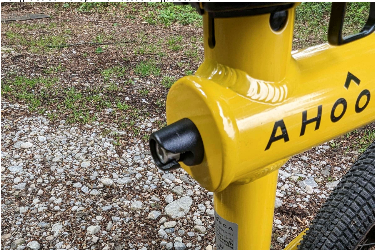
Dieser Zapfen sorgt für eine sichere Verbindung zum Hinterbau.
